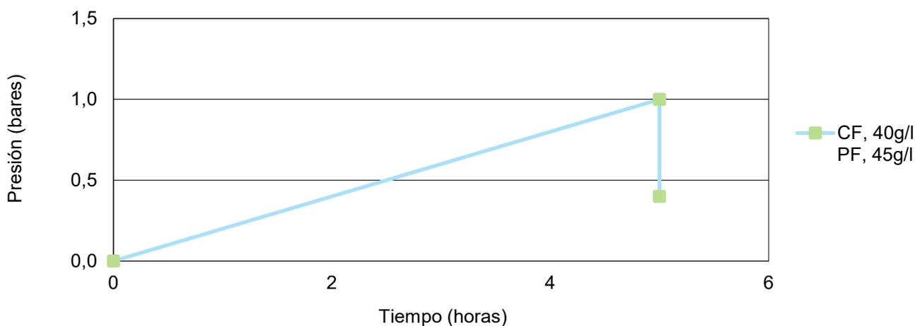
Los ciclos de pretratamiento pueden adaptarse según el proceso de moldeo, la densidad y la geometría de la pieza: Si la presión celular interna es demasiado alta, pueden producirse problemas de fusión. En este caso, reduzca el tiempo, la presión o la temperatura para mejorar la fusión.
