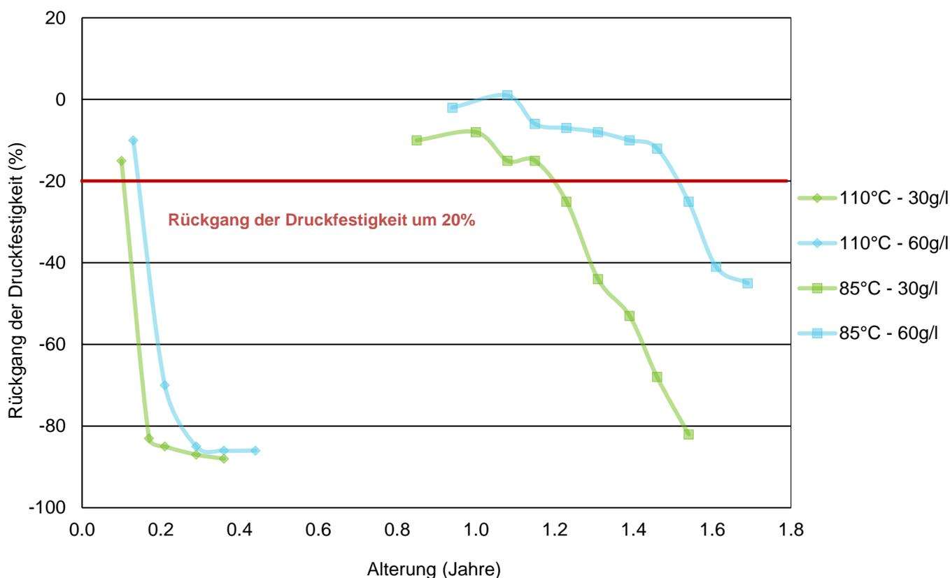
**Erklärung der Testergebnisse:** Bei einer konstanten Temperatur von 110°C tritt bei ARPRO mit Dichten von 30g/l und 60g/l nach zwei Monaten eine Schädigung und ein Rückgang der Leistung ein. Bei einer konstanten Temperatur von 85°C verliert ARPRO mit einer Dichte von 30g/l nach 15 Monaten 20% der ursprünglichen Druckfestigkeit. Bei ARPRO mit einer Dichte von 60g/l tritt dieser Rückgang nach 18 Monaten ein.
