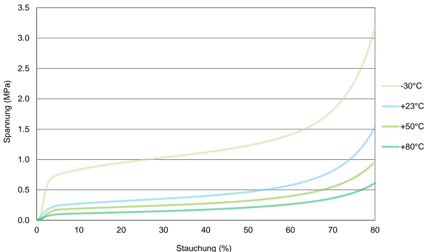
**Erklärung der Testergebnisse:** Unter Hitzeeinwirkung wird ARPRO weicher; ein Rest an Festigkeit bleibt aber selbst bei hohen Temperaturen erhalten. Das allgemeine thermoplastische Verhalten bleibt unabhängig von der Prüftemperatur stabil. Dies gilt auch unterhalb der Glasübergangstemperatur (ca. -20°C).
