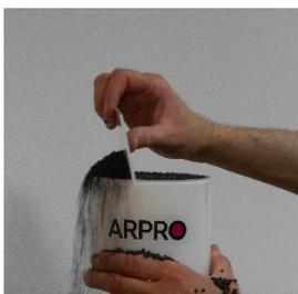
3. Den Behälter mit dem Abstreichlineal abziehen, um überschüssiges Material zu entfernen und ein Volumen von einem Liter zu erhalten. Nicht komprimieren.
