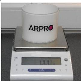
1. ARPRO Behälter auf die Waage stellen und Waage tarieren.
