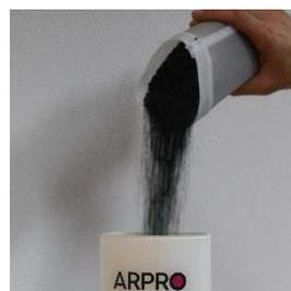
2. Material vorsichtig in einem Schüttwinkel von 45° in den Behälter geben, entweder mithilfe eines Gefäßes oder einfach per Hand\*\*\*. Erschütterungen oder erzwungene Verdichtung vermeiden.
