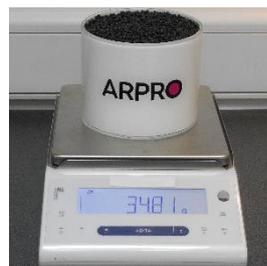
4. Den gefüllten Behälter wiegen und das Ergebnis mit einer Genauigkeit von bis zu einer Dezimalstelle festhalten.
