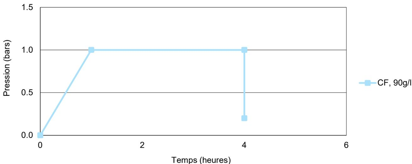
Les cycles de prétraitement peuvent être adaptés en fonction du procédé de moulage, de la densité et de la géométrie de la pièce :
