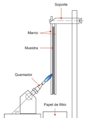
Para las clases E y F, solo se requiere realizar la prueba de ignición con una llama pequeña. Para las clases A1, A2, B, C y D, es necesario realizar la prueba de la norma EN 13823.
