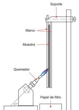
Para las clases E y F, solo se requiere realizar la prueba de ignición con una llama pequeña. Para las clases A1, A2, B, C y D, es necesario realizar la prueba de la norma EN 13823.
