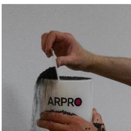
3. Livellare il contenitore utilizzando la squadra per regolare il volume del materiale affinché corrisponda a un litro, rimuovendo l'eccesso. Non comprimere.
