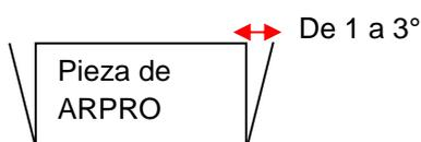
Todos los radios se pueden moldear excepto en la línea de separación de las herramientas.
