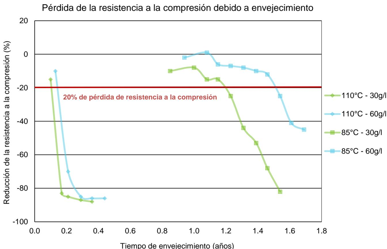
**Explicación de los resultados de la prueba:** con una temperatura constante de 110°C, el material ARPRO a 30g/l y 60g/l empezará a degradarse y perder rendimiento después de dos meses. Con una temperatura constante de 85°C, el material ARPRO a 30g/l perderá el 20% de su resistencia inicial a la compresión después de 15 meses. En el caso de ARPRO a 60g/l, esta degradación se alcanzará después de 18 meses.
