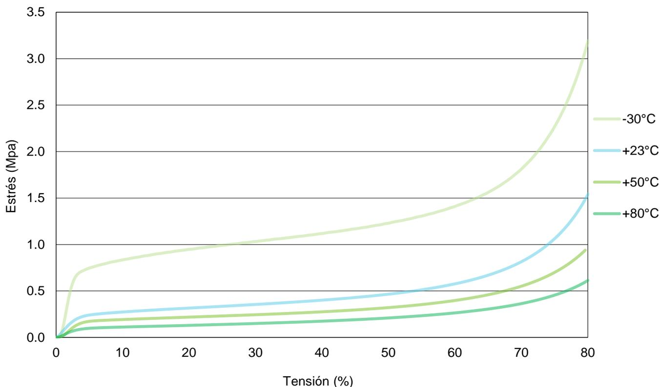
**Descripción del resultado de la prueba:** Cuando ARPRO se somete al calor, el material se ablanda; se mantendrá alguna resistencia residual, incluso a altas temperaturas. El comportamiento termoplástico general se mantendrá estable sea cual sea la temperatura comprobada, incluso por debajo de la temperatura de transición vítrea (aprox. -20°C).
