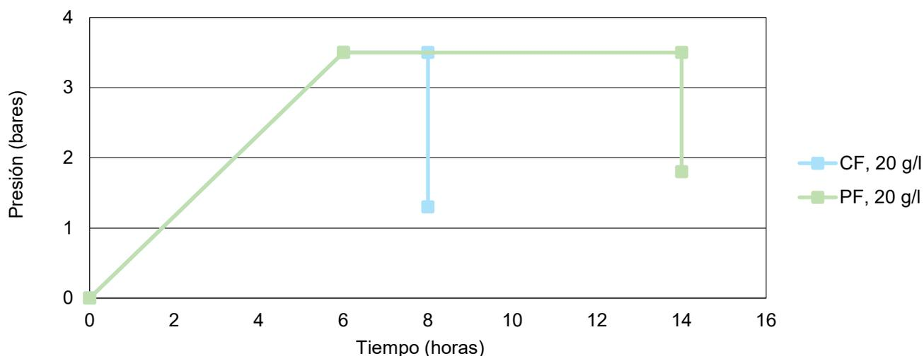
Los ciclos de pretratamiento pueden adaptarse según el proceso de moldeo, la densidad y la geometría de la pieza: Si la presión celular interna es demasiado alta, pueden producirse problemas de fusión. En este caso, reduzca el tiempo, la presión o la temperatura para mejorar la fusión.
