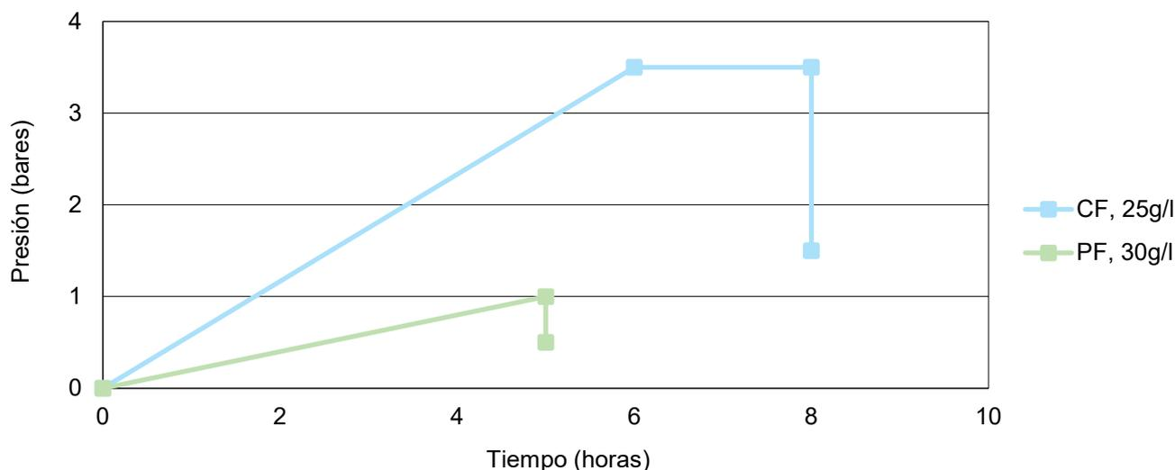
Los ciclos de pretratamiento pueden adaptarse según el proceso de moldeo, la densidad y la geometría de la pieza: Si la presión celular interna es demasiado alta, pueden producirse problemas de fusión. En este caso, reduzca el tiempo, la presión o la temperatura para mejorar la fusión.
