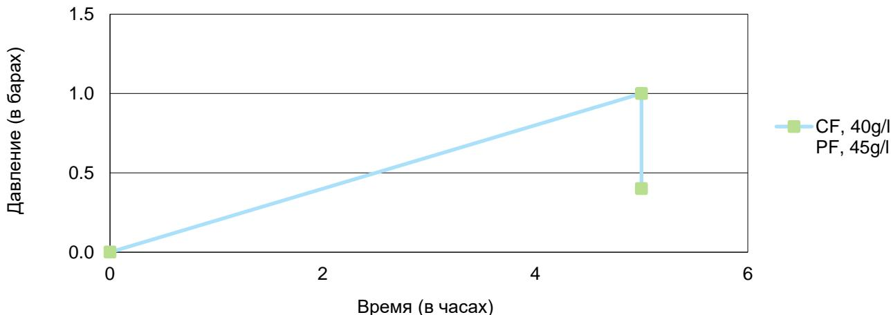
Циклы предварительной обработки могут быть адаптированы в соответствии с процессом формования, плотностью и геометрией детали:
