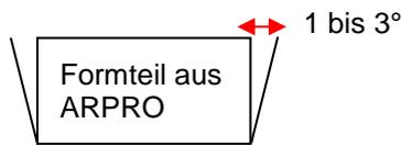
Jegliche Radien können geformt werden, solange sie sich nicht an der Trennlinie des Werkzeugs befinden.
