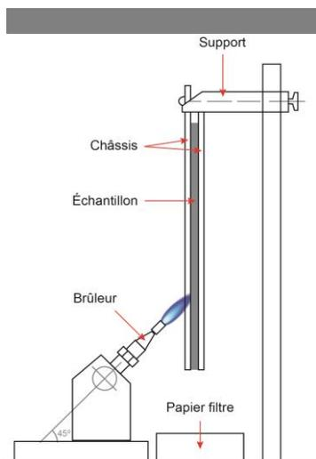
Pour les classes E et F, seul l'essai d'allumage avec une petite flamme est requis. Pour les classes A1, A2, B, C et D, l'essai EN 13823 est requis.
