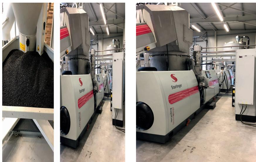
**Bild 3.** Im hessischen Eschwege werden die gesammelten Ladungsträger zu EPP-Regranulat verarbeitet und anschließend im Labor auf Schlüsselkriterien untersucht (© GID)
