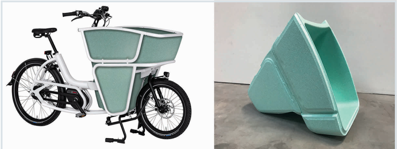
Bild 4. Machbarkeitsstudie für das Lastenrad Urban Arrow Shorty: Der Transportbehälter wurde komplett aus dem Partikelschaum Aprro 35 Ocean gefertigt © Urban Arrow, JSP
