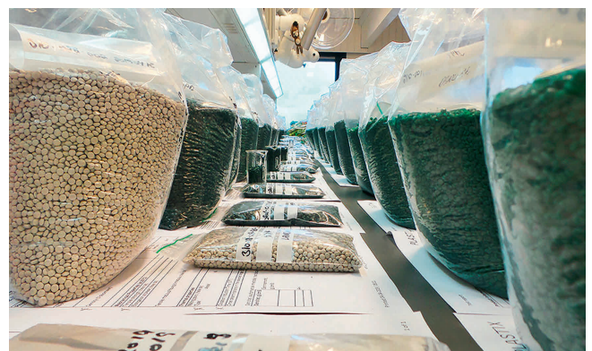
Bild 3. Vor der Auslieferung werden die Rezyklate analysiert und einer Qualitätskontrolle unterzogen © Plastix
