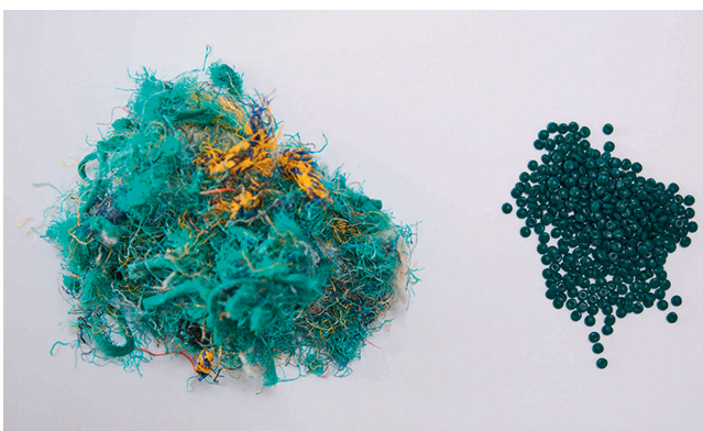
Bild 2. Durch mechanisches Recycling wird aus den maritimen Abfällen wieder hochwertiges Kunststoffgranulat © Plastix
